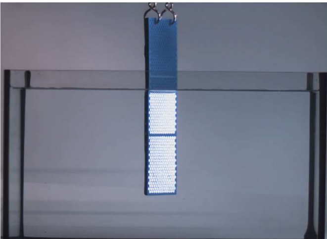
Abb. 2: Totalreflexion an der Luftschicht einer eingetauchten Polymerprobe
